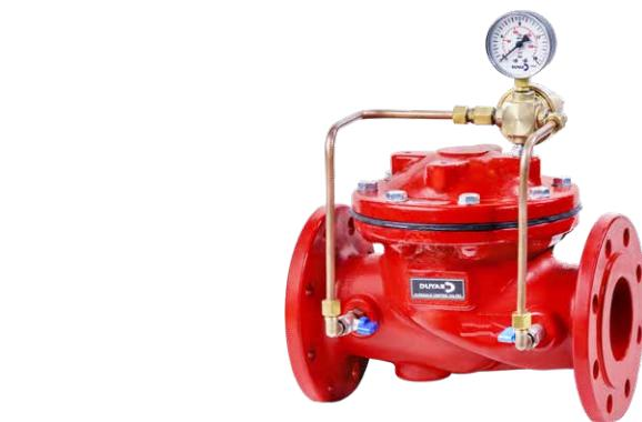
Basınç düşürücü hidrolik kontrol vanaları, su iletim şebeke hatlarındaki yüksek basınç değerini istenilen daha düşük bir değere düşürmek için kullanılır. Basınç düşürücü kontrol vanaları, şebedekedeki akış ve debi değişimlerinden etkilenmeden ayarlanan çıkış basınç değerini korur. Vana çapı seçimi yapılırken boru çapı dikkate alınmaz. Vana çapı boru çapının küçük veya bir büyük değerinde seçilebilir. Vana çapı seçimi yapılırken kavitasyon değerleri dikkate alınmalıdır.
