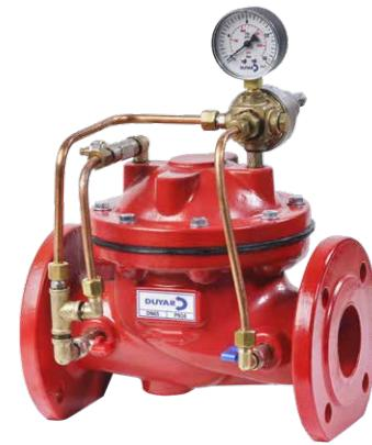
Hızlı basınç tahliye kontrol vanaları; sistemdeki basıncın belli bir limit değerinin üzerine çıktığında, açılarak fazla basıncın dışarı atılması ile sistemi rahatlatmak için kullanılır. Sistem basıncı vananın ayarlı olduğu limit değere düşüğünde vana tekrar kapanır. Relief vanaların basınç değeri üzerinde kullanılan pilot valf sayesinde ayarlanır. Pilot valf'in ayarlanan set değeri çıkışındaki geri basınçtan etkilenmez.
