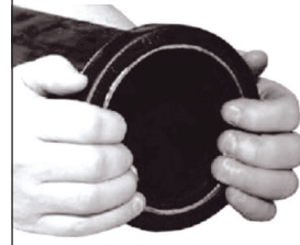
3. Conta montajı Gasket installation
