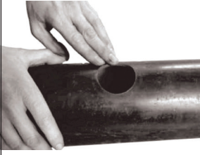
1. Boru hazırlığı Pipe preparation
